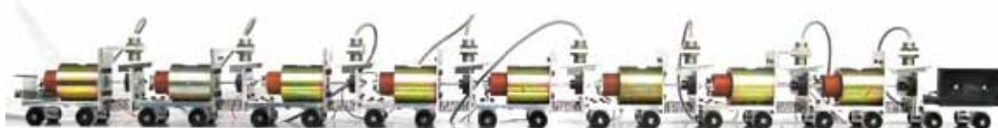
摩擦の大きい路面における8自由度のばね・質点系とみなせる連結台車のモード形成
